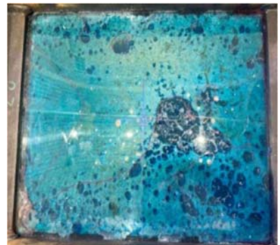
図-14 2次注入状況(硬化後)
