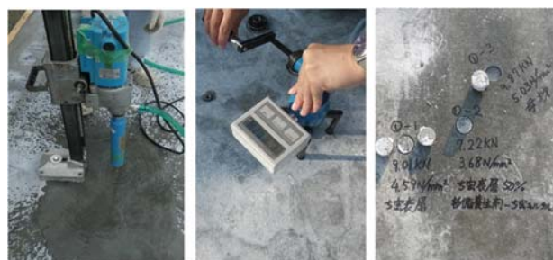
図-8 付着試験実施状況
