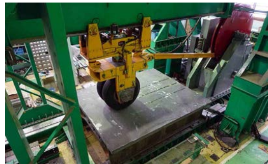
写真-1 輪荷重試験状況 (ゴムタイヤ)
