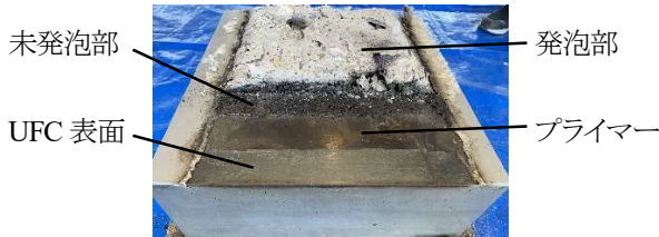
写真-3 未発泡の様子
