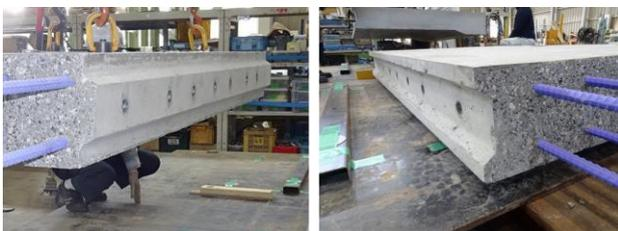
図-3 縦目地部の接合キー外観
