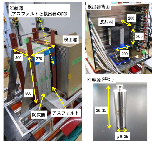
図-2 計測時の写真。装置全体(左)、 検出器裏側(右上)、および RI 線源(右下)。
