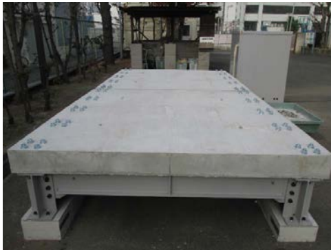
写真-2 模擬 RC 床版試験体
