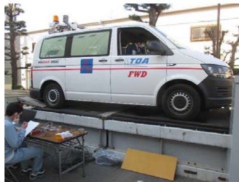
写真-4 FWD 試験状況
