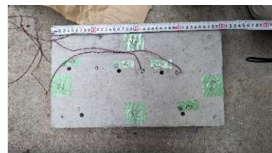
b) 試験体 (削孔後)
