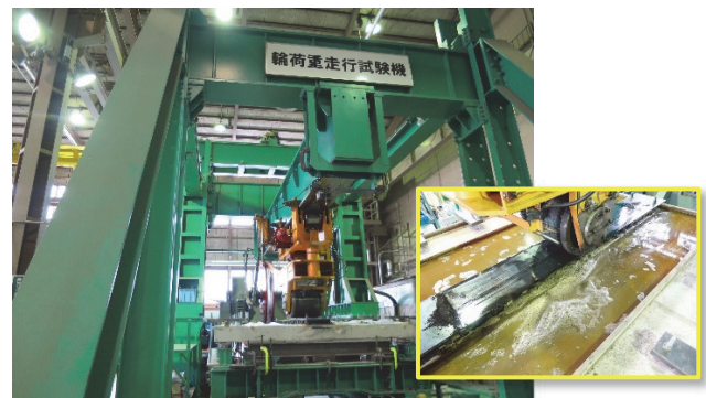
写真-2 輪荷重走行試験機と水張り試験状況
