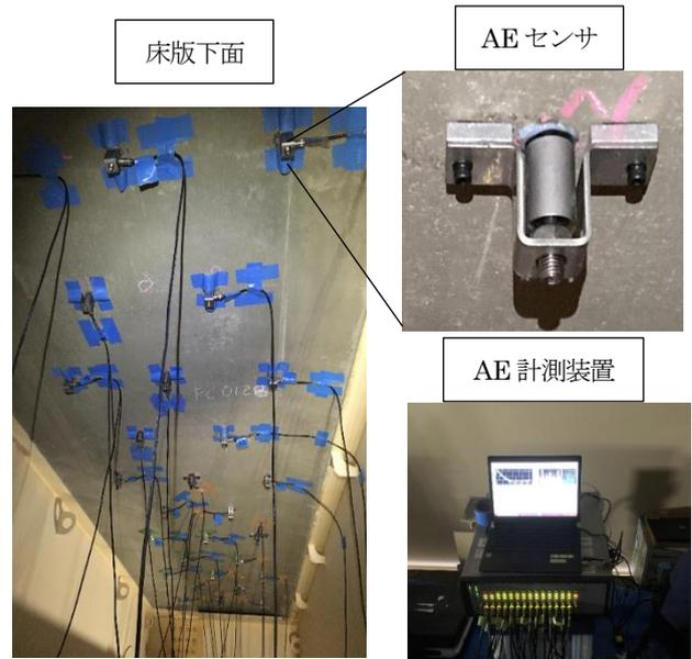
図-4 AE 計測の様子
