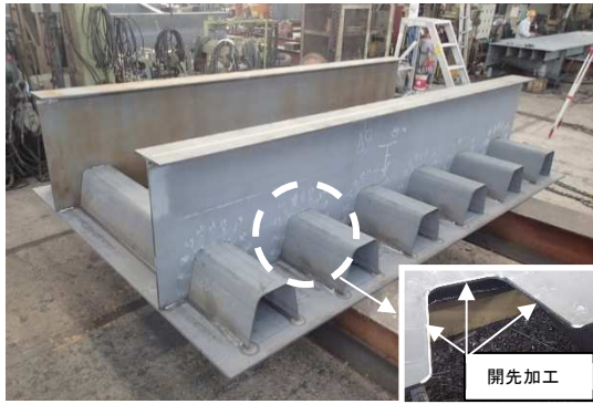
写真-1 施工試験体
