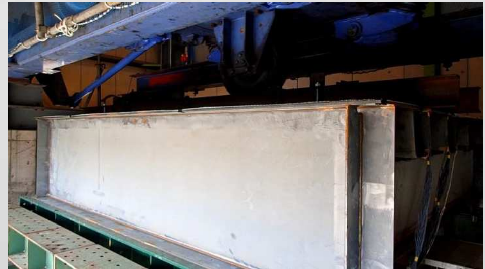
移動輪荷重試験の例
