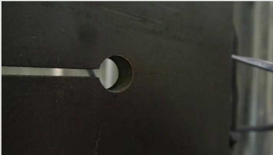
油圧ジャッキによる疲労試験の例
