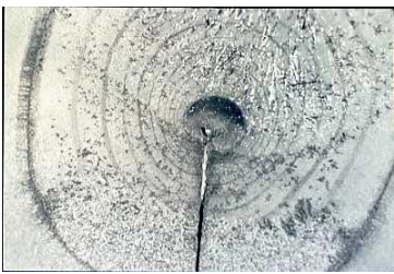
ビーチマークの間は同じ繰り返し数 ビーチマークの間隔から進展速度がわかる
