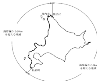
図-第1.3.4 耐候性鋼橋梁の適用地域
