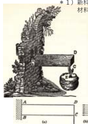
ガリレオによる曲げ試験の説明図
