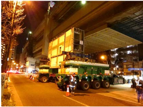
図-22 自走式多軸台車での移動状況
