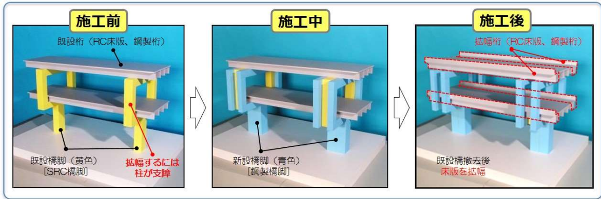
図-11 サンドイッチ工法
