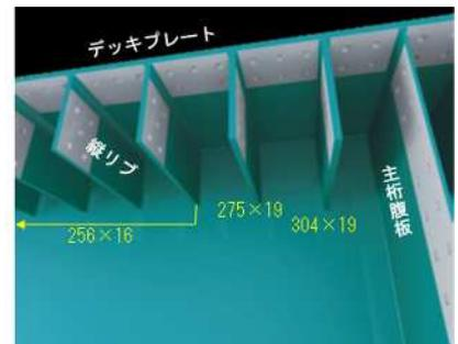
図-10 縦リブ全周溶接構造
