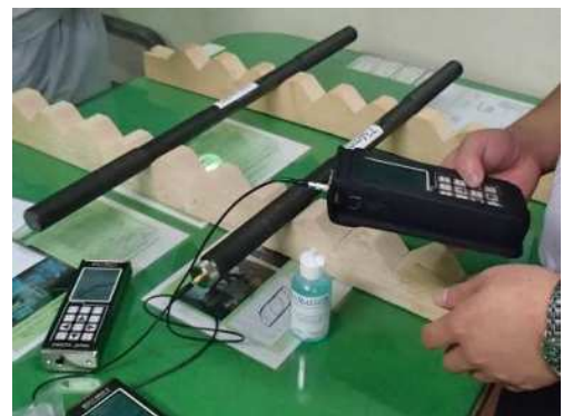
写真-5 ボルトの無応力長計測
