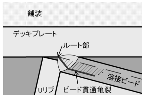
図-8 ビード貫通亀裂
