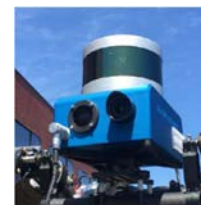
図-13 LiDAR-SLAM センサ
