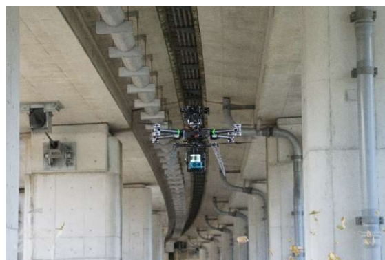
図一15 曲線橋の桁下飛行
