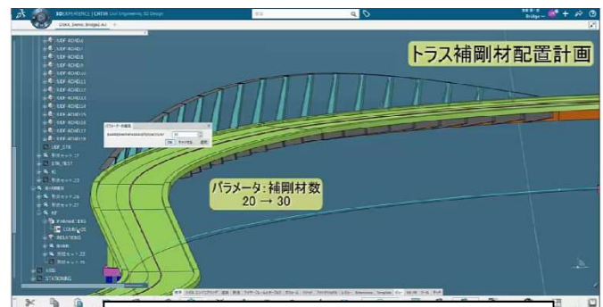
図 2-3 曲線鋼歩道橋の例 (その 2)
