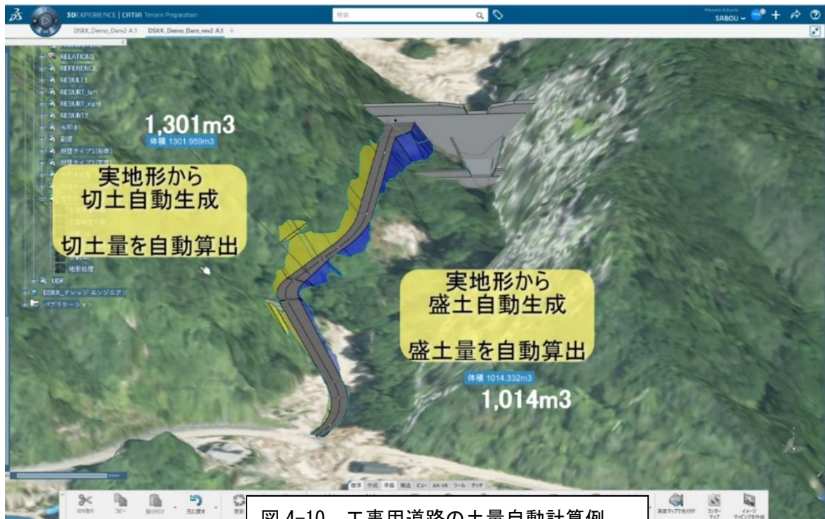
図 4-10 工事用道路の土量自動計算例
