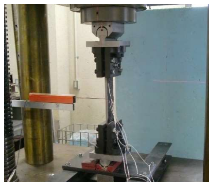
図-6 腐食鋼板の座屈試験
