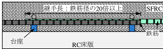
図-2 補強筋重ね継手構造の概略
