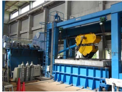
写真-2 輪荷重走行試験状況
