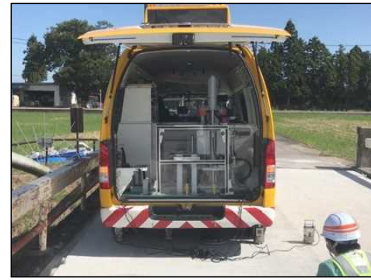
写真-6 FWDによるたわみ量測定状況
