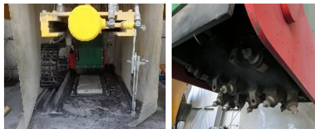
(a)定置式切削装置外観 (b)切削ビット 写真-2 定置式切削装置
