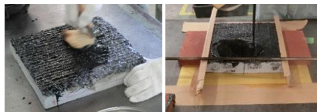
(a) 防水材塗布(刷毛) (b) 防水材流し込み
