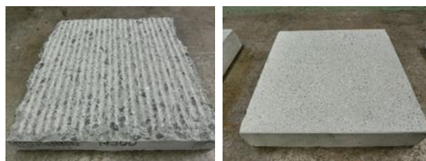
(a)切削面 (b)平滑面 写真-3 平板供試体の表面状況
