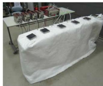
図-12 鋼床版試験体の部分加熱状況
