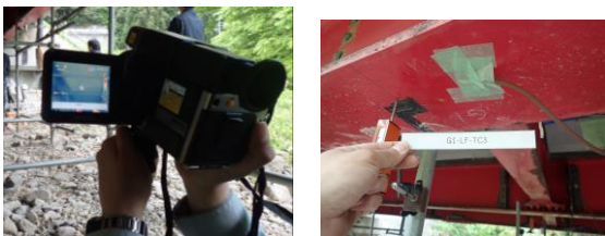
図-4 温度計測実施状況 (左：赤外線カメラ，右：熱電対)
