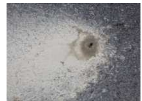
(a) 砂利化の例 (b) 舗装面の土砂噴出 写真-1 床版の土砂化とその変状
