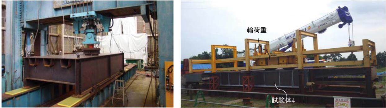
写真 4.5.1 疲労試験の様子<sup>1)</sup>
