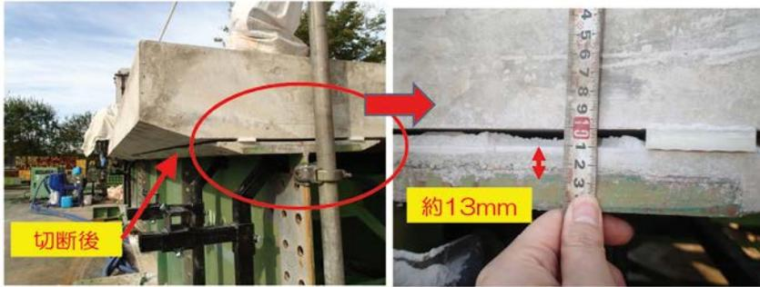
写真 4.7.2 無水式ワイヤーソーによる切断後断面
