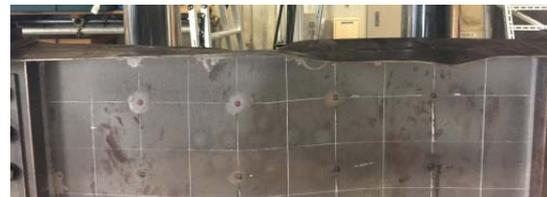
(a) 試験体 2A (CFRP シートなし)
