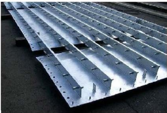
(a) スタッドを溶着したバルブプレートを使用した例 46)
