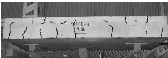
(a) 膨張コンクリートを使用しない場合
