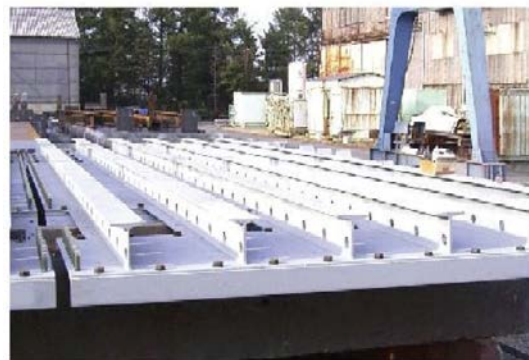
(d) 孔あきT形リブを使用した例 46)
