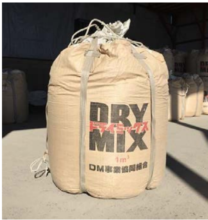
写真-2 フレキシブルコンテナパックを用いた材料の貯蔵・計量方法
