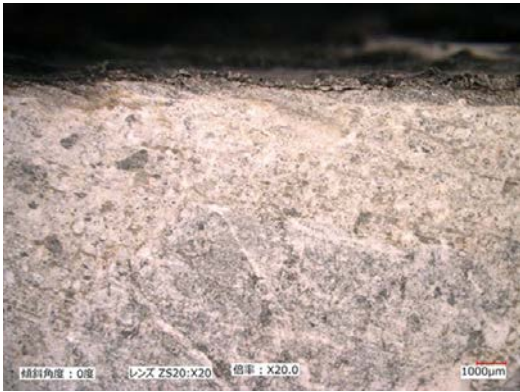
写真-9 W/C=35%,Air=1.5%, 28日養生, 高浸透型複合防水層, 含水率大の円柱試験体の断面の様子
