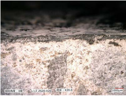
写真-8 W/C=55%,Air=6.0%, 28日養生, アスファルト塗膜系防水層, 含水率大の円柱試験体の切断面の様子
