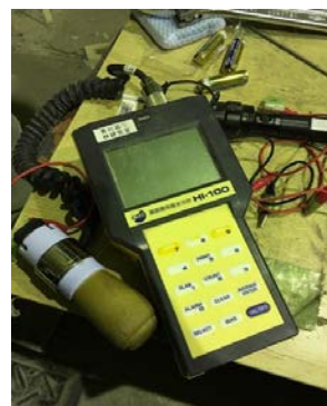
写真-1 使用した含水計（Kett社、HI-100）
