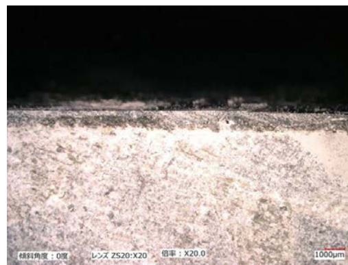
写真-7 W/C=35%, Air=1.5%, 1日養生, アスファルト塗膜系防水層, 研磨有, 含水率大の円柱試験体の切断面の様子
