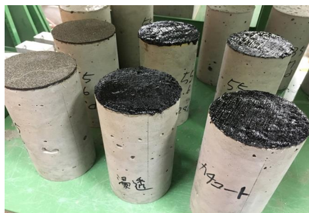
写真-2 3種類の防水層を施工した円柱試験体（左からアスファルト塗膜系防水層、高性能型シート系防水層、高浸透型複合防水層）
