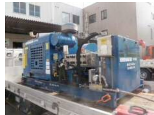
写真-9 超高圧発生装置
