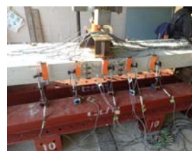
図-14 1点曲げ試験状況
