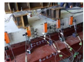
図-13 2点曲げ試験状況
