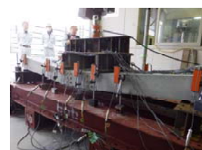
図-15 1点曲げ試験状況
