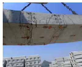
図-20 2点曲げ試験破壊状況 （継手あり）
