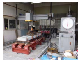
図-12 2点曲げ試験状況
