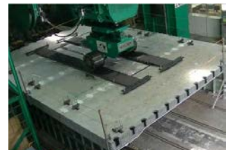
写真-5 輪荷重走行疲労 試験 (NEXCO 総研所有)
