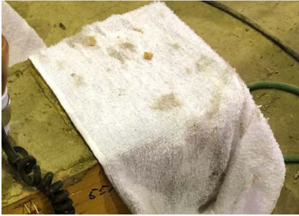
写真-3 試験体仕上げ面を湿潤養生している様子
