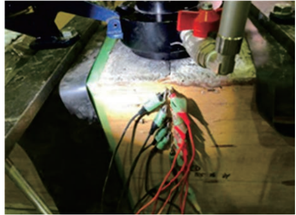
写真-4 試験中に電極棒間の電気抵抗を計測している様子
