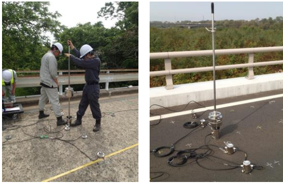
図-1 小型 FWD 試験実施状況
