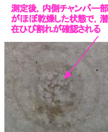
(a) 潜在ひび割れありの高透水性の普通コンクリートの場合 (w=5.22cc, P 値=5.271 × 10 -10 m/s, 乾燥収縮ひずみ 800μ)
