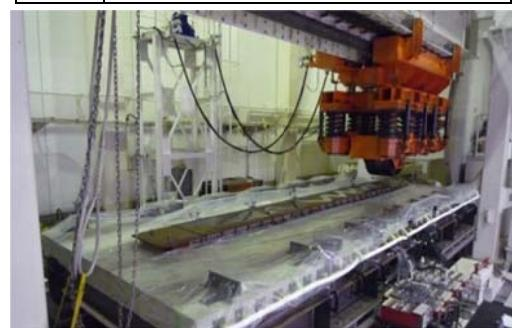
図-3 輪荷重走行試験機
