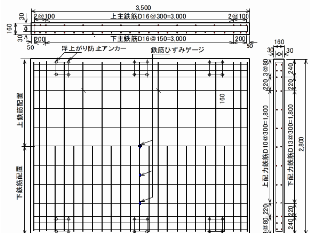
図-1 試験体の形状寸法
