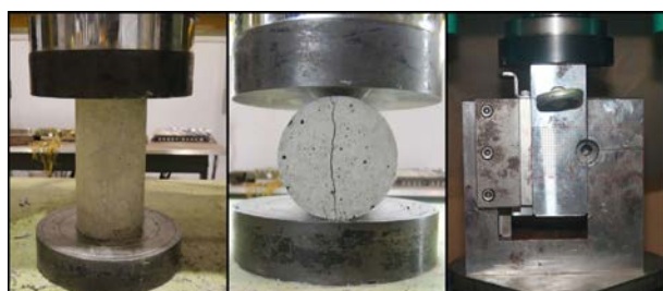
(1) 圧縮試験 (2) 割裂試験 (3) 一面せん断試験 写真-1 各種試験状況 3), 4)
