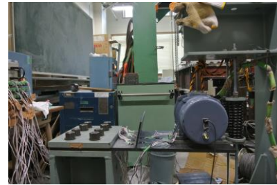
写真-2 Uリブ振動疲労試験状況
