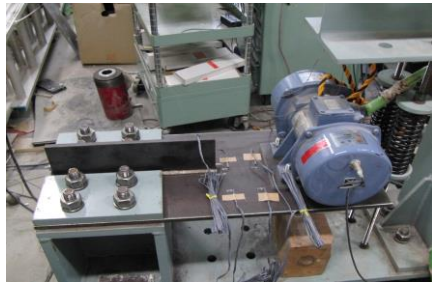
写真-1 面外ガセット溶接継手疲労試験状況
