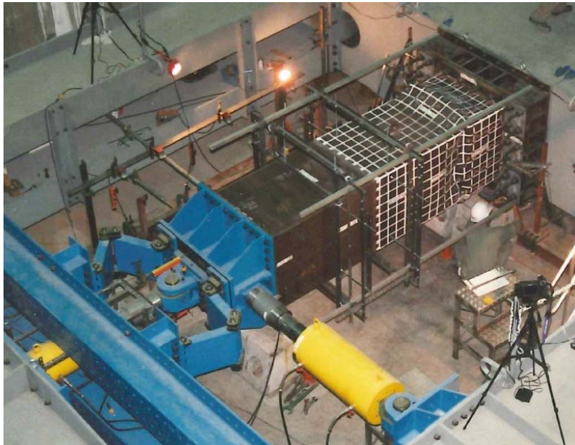
鋼製橋脚の正負交番载荷実験の例 (写真提供:土木研究所)
