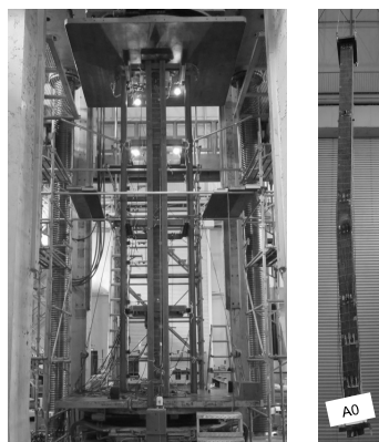
写真-6 荷重試験全景と崩壊形状
