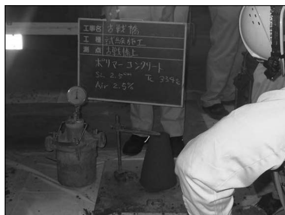
写真-5.3.6 LMCの性状試験
