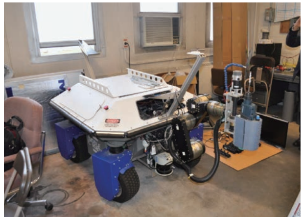
橋面コンクリート舗装調査診断ロボット
