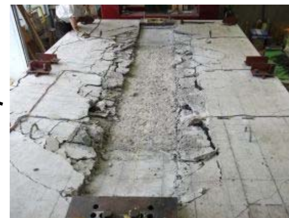
〔試験終了後の床版上面の状況〕
