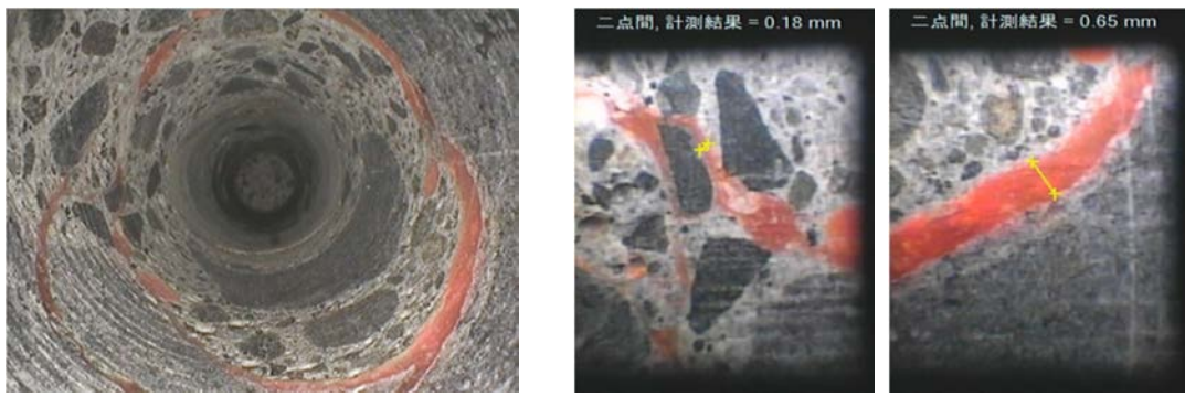
(a) 直視レンズによる測定結果 (b) ひび割れ幅の測定結果
