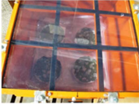
(a) 真空脱泡の実施状況
