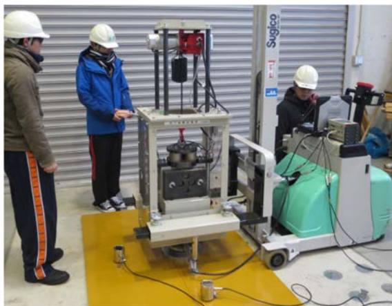
図-付 2. 2. 10 自走式衝撃加振装置（SIVE 法）による床版の健全性調査
