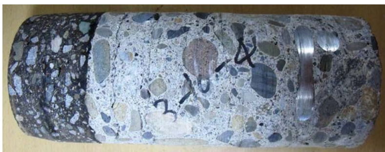
図-付 1.6 事例 1, 床版切断面の水平ひび割れ
