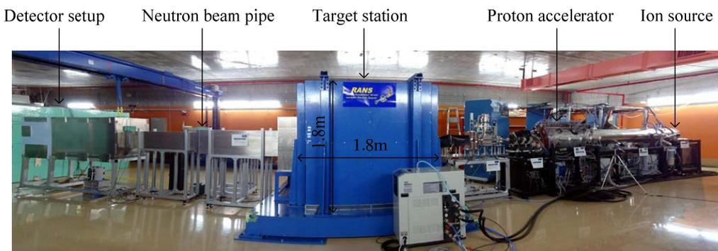
図-1 理研小型中性子源システムRANSの外観
